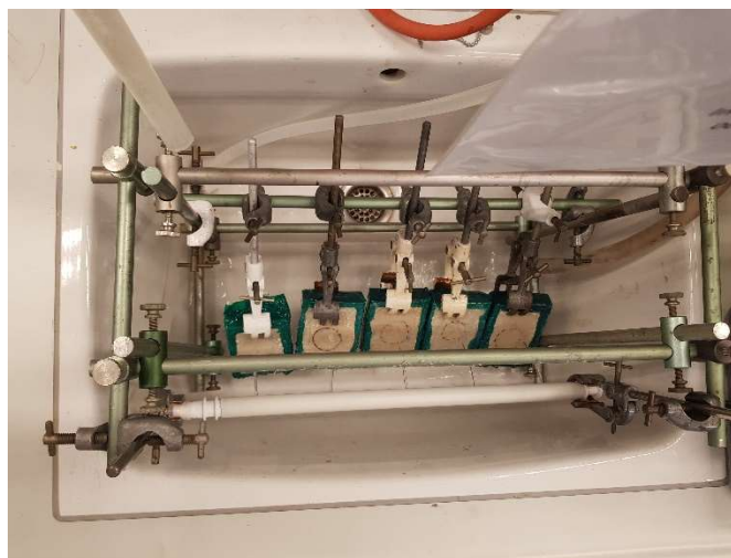
Foto links: Gesimuleerde regen op gecoate zandsteen monsters.
